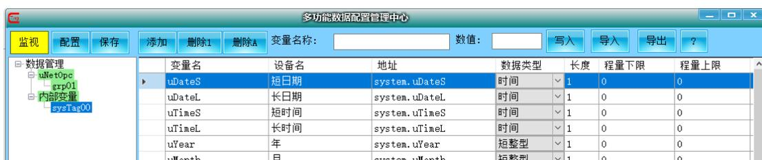
在上图中 右键单击 “数据管理” 根节点，可以添加 OPC 驱动节点（来自不同的 OPC 连接），弹出如下界面，
